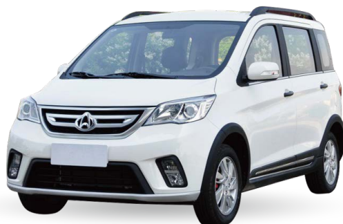
重庆长安 欧力威 额定电压：333V 额定容量：104Ah 电量：34.6kWh
