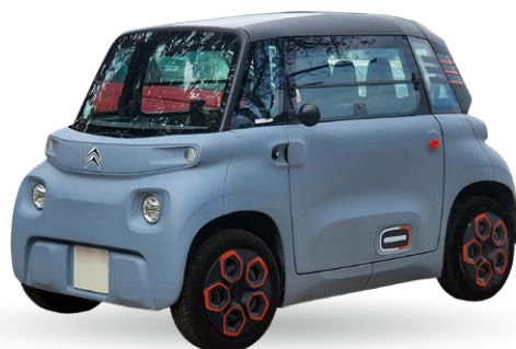
海外 小型乘用车 额定电压：48V 额定容量：120Ah 电量：5kWh
