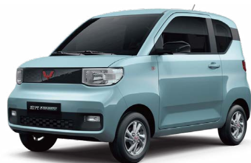
上汽通用五菱 宏光MINI EV 额定电压：96V 额定容量：96.9Ah/144Ah 电量：9.3kWh/13.8kWh
