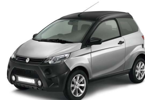
海外 小型乘用车 额定电压：48V 额定容量：120Ah 电量：5kWh
